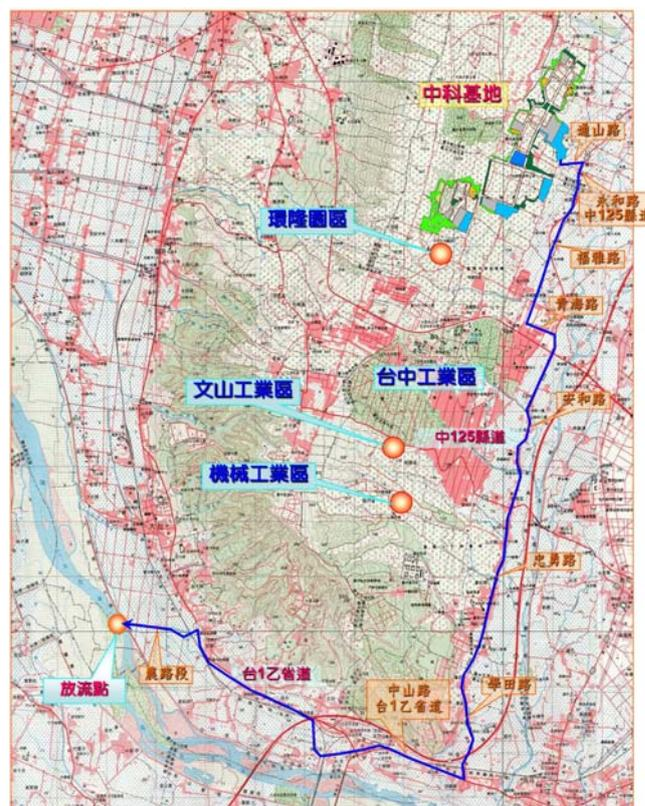
圖 3-12 中科台中基地污水放流管配置圖
