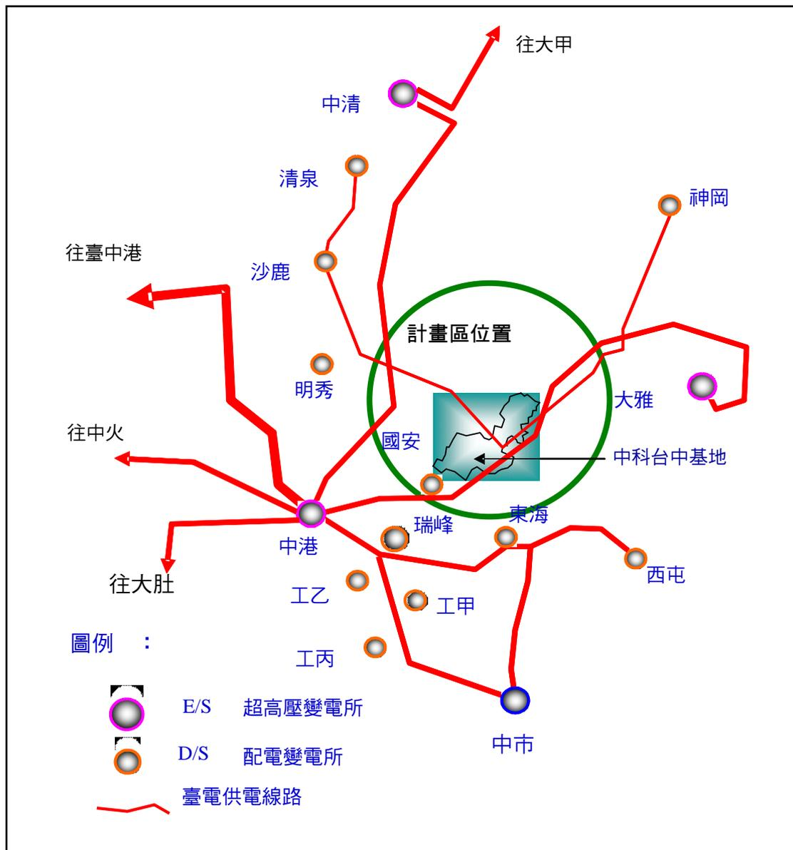
圖 3-11 鄰近地區電力系統示意圖
