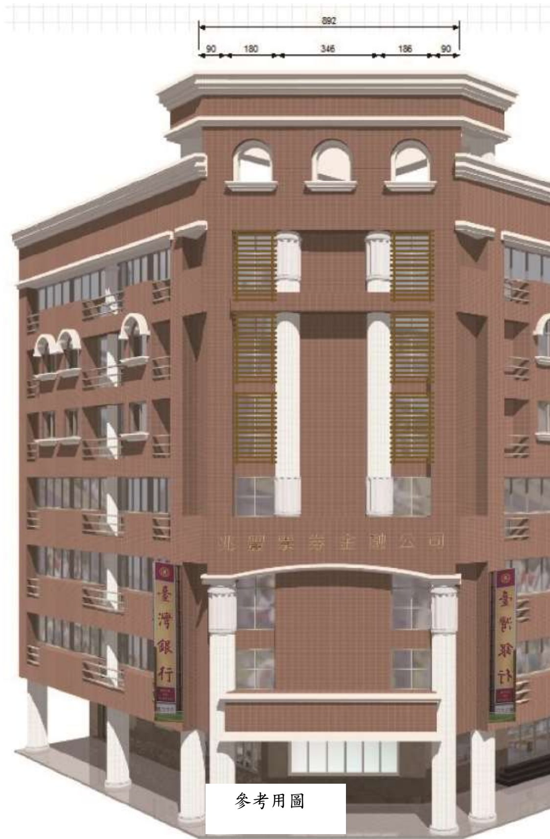
圖 7-4 ○○○○大樓正面冷氣格柵示意圖
