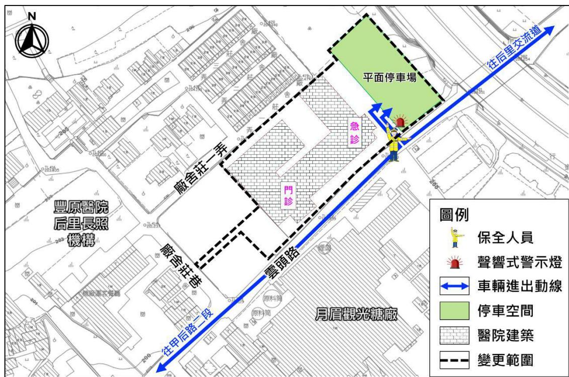
圖 3-4 停車場出入口管制示意圖
