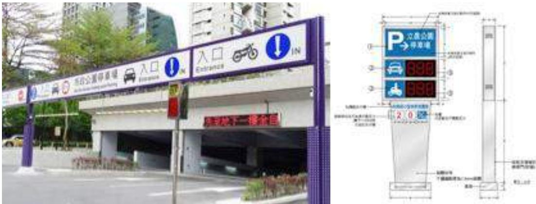
圖 4-2 地下停車場限高架與剩餘格位顯示圖
