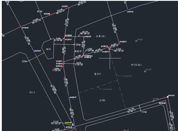
3.利用系統歷史底圖清查舊有座標坐落概況並依據計畫圖CAD預為進行樁位點座標放樣。
