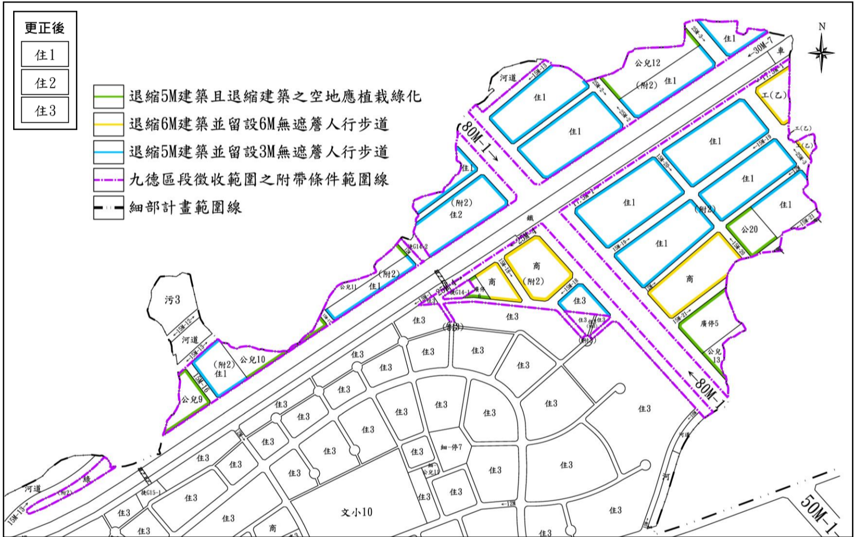
附圖2 原「變更烏日都市計畫(配合九德地區區段徵收開發)案」之退縮建築規定示意圖
