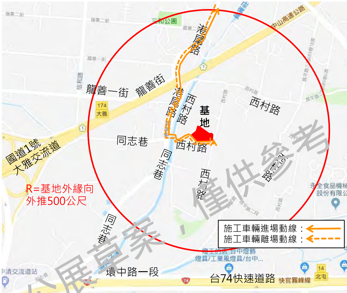
圖 18 施工車輛進離場動線圖
