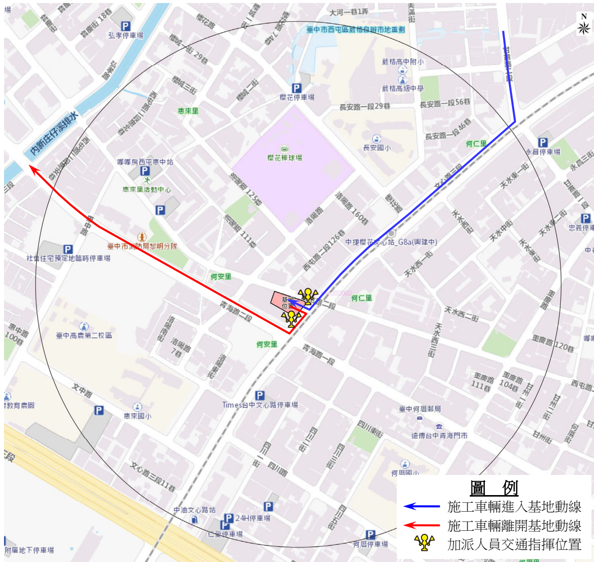
圖 3-1 施工階段運輸動線示意圖
